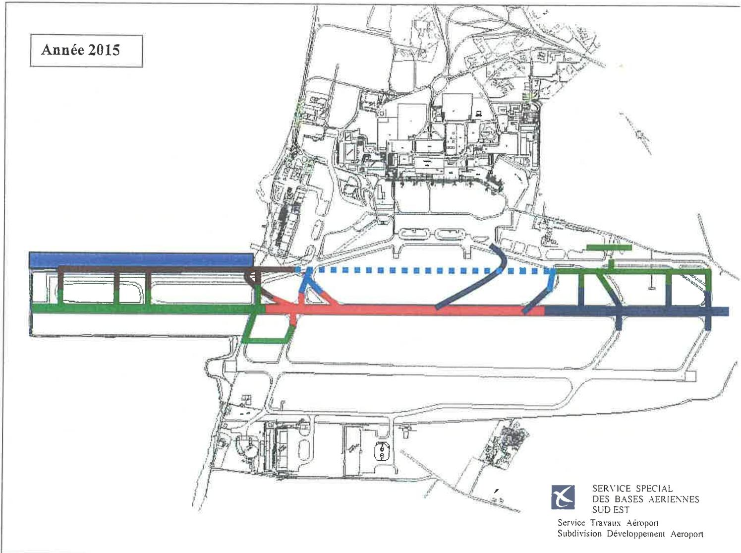
La piste 1 est optimisée et saturée. L'hélistation a été créée et plusieurs dégagements à grande vitesse ont été rajoutés en QFU 14 et QFU 32. Dans cette configuration de moyen terme, le système de piste est saturé. La capacité calculée est de l'ordre de 140 000 mouvements commerciaux.
