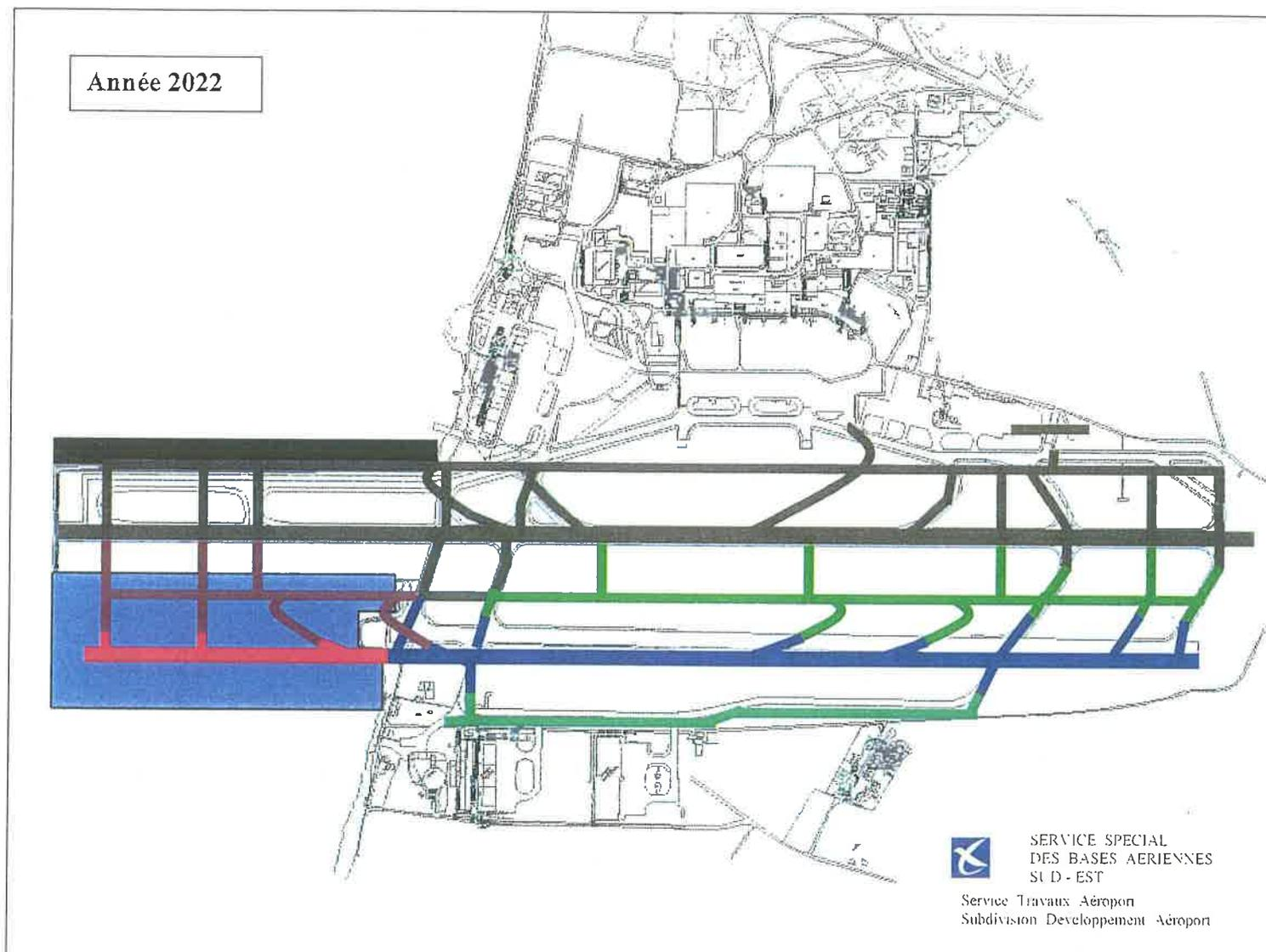
En se projetant sur le long terme, le doublet de pistes spécialisées sera réalisé. La piste 1 sera réservée aux décollages et la piste 2 aux atterrissages. Le système de piste permettra une importante augmentation de capacité. Dans le cadre des hypothèses proposées, une capacité de 180 000 mouvements commerciaux est retenue ; il ne s'agit pas de la saturation complète du système.
